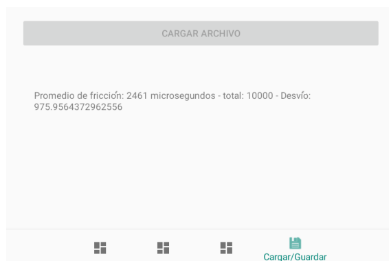
Fig. 4.6: Información sobre costos de cambiar la fricción en el dispositivo. El promedio y la desviación corresponde a los valores enviados cada 300 ms en las pruebas. El límite de interacciones con la fricción y palanca tomado es 50 mil (para evitar overflow en caso que el test se corra por muchas horas).
