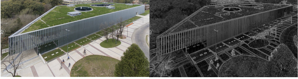
Fig. 2.2: Resultado de aplicar el filtro Sobel para detectar los bordes de la imagen de la izquierda.
