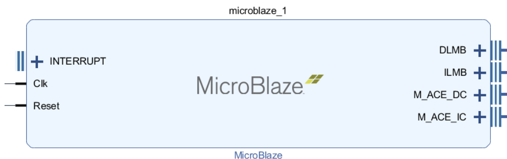
Figura 1.11: Ejemplo de IP Core MicroBlaze en Vivado configurado para su uso en este trabajo. A la izquierda están los puertos de control ( slave ) y a la derecha se encuentran los de acceso a memoria ( master ).
