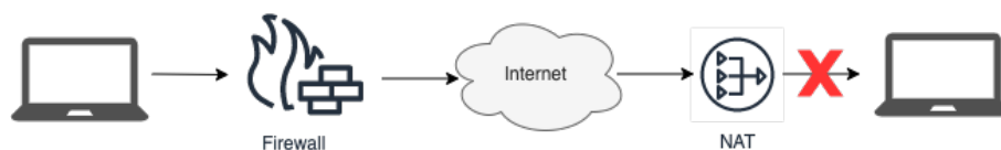
Figura 2.2: Una comunicación entre dos dispositivos puede tener que pasar por varios middleboxes. Los Firewalls y NAT gateways son ejemplos comunes de estos componentes.
