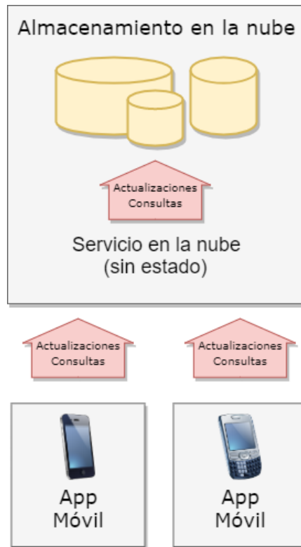
Fig. 1.1: Arquitectura de las Web-based applications.
