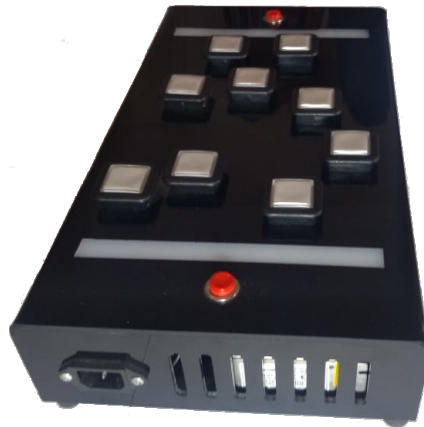
Fig. E.5. Vista lateral del CorsiBot. Se observa el conector de alimentación a 220 Volts.
