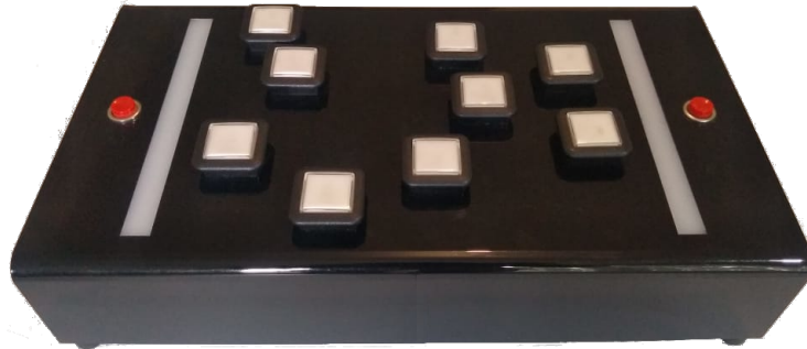
Fig. 2.7. CorsiBot. Vista frontal desde la posición de la persona que realizará la evaluación. Pueden observarse los 9 botones cuadrados con luces con la misma distribución que la versión original, los dos botones rojos laterales de confirmación y siguiente secuencia y las dos barras verticales traslúcidas que se iluminan mediante leds RGB.
