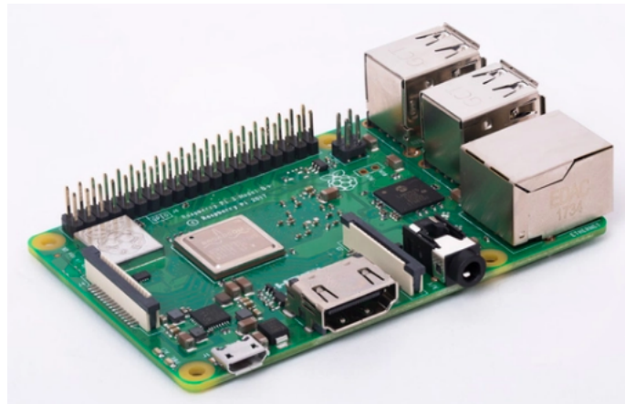
Fig. 2.4. Raspberry Pi 3B+. Se seleccionó este sistema embebido puesto que provee las funcionalidades para controlar los puertos de entrada/salida en la cantidad necesaria y cuenta con hardware para conexión wifi. Además permite la ejecución de un sistema operativo lo que brinda muchas posibilidades de instalación de paquetes tanto para el desarrollo como para su uso.
