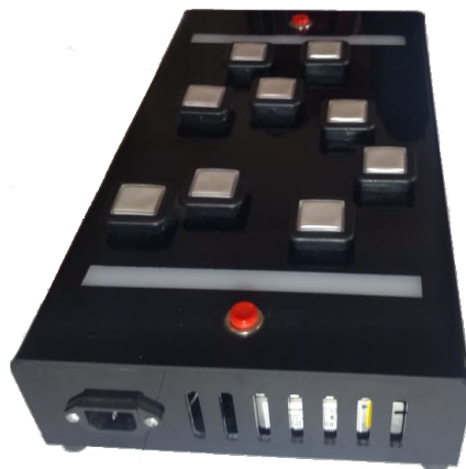
Fig. 2.8. Vista lateral del CorsiBot. Se observa el conector de alimentación a 220 Volts.
