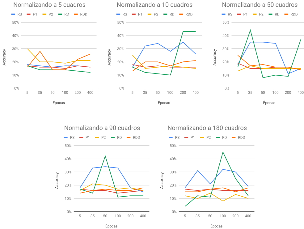
Fig. 6.1: Resultados del experimento Leave One Out. Se muestra la accuracy obtenida por cada una de las redes clasificadoras en función de la cantidad de épocas de entrenamiento. En todos los casos, los atributos utilizados fueron los generados con la red ID.
