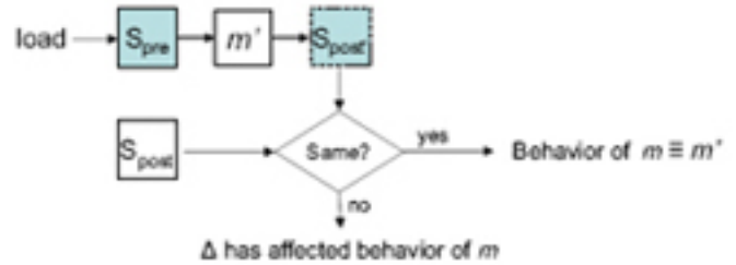
Figura 7. Ejecución de un test de unidad utilizando estados capturados
