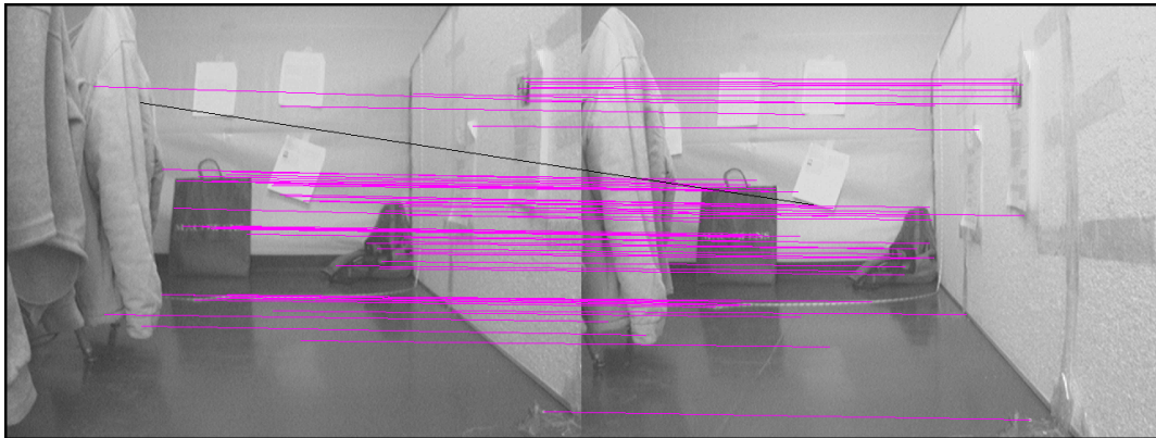
Fig. 6.4: Correspondencias detectadas utilizando un árbol k-d para las dos imágenes correspondientes a la primer iteración del caso 4. Se muestran 66 correspondencias detectadas correctamente y 1 incorrectamente.
