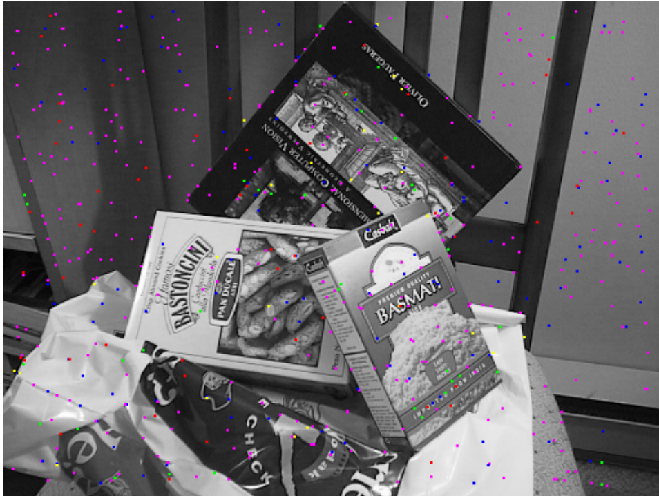
Fig. 7.9: Marcas de la imagen para una ventana de 11 \times 11 y un umbral k = 0,75 . Los puntos azules y magentas se corresponden con los niveles inferiores de escala.
