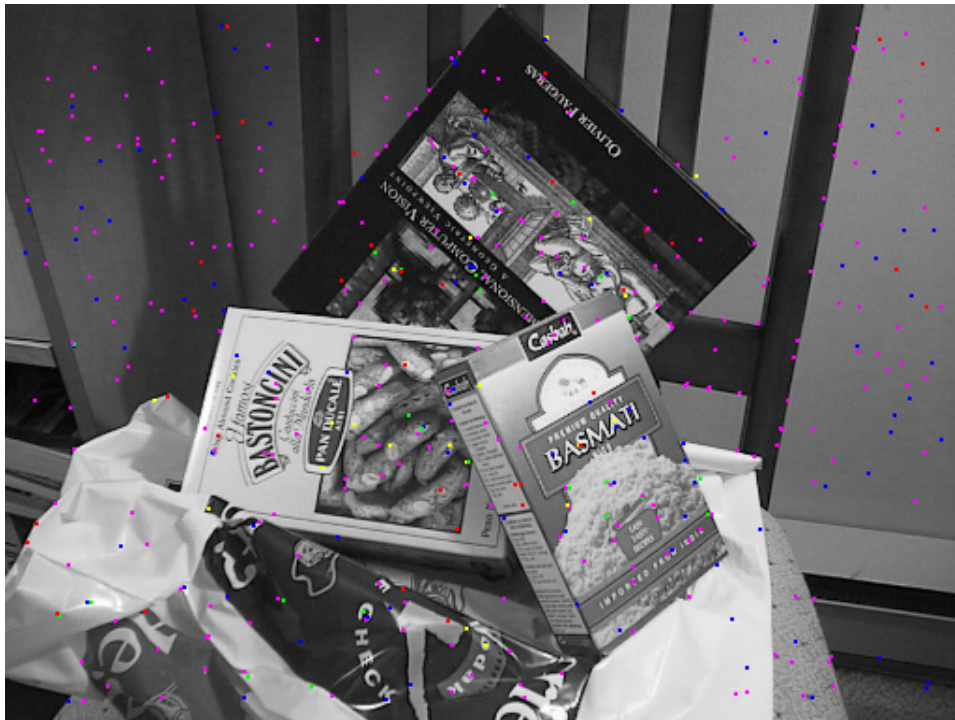
Fig. 7.10: Marcas de la imagen para una ventana de 15 \times 15 y un umbral k = 0,5 . Los puntos azules y magentas se corresponden con los niveles inferiores de escala.
