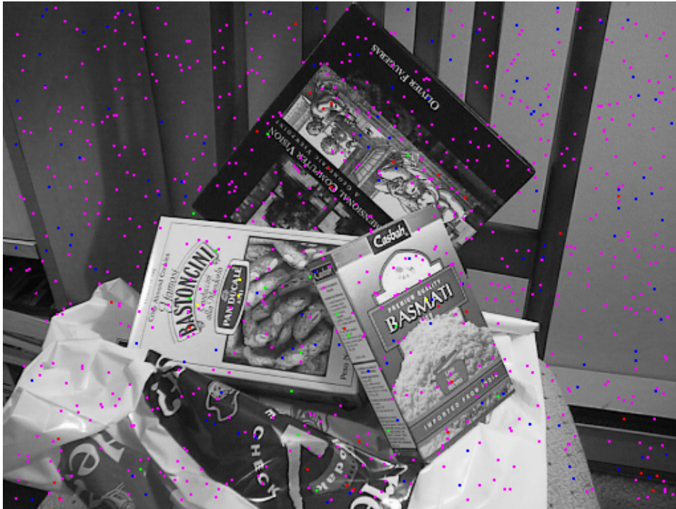
Fig. 7.7: Marcas de la imagen para una ventana de 3 \times 3 y un umbral k = 6 . Los puntos azules y magentas se corresponden con los niveles inferiores de escala.
