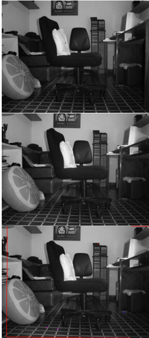
Fig. 7.13: Dos imágenes de la misma habitación tomadas una a 10 cm a la izquierda de la otra. En la tercera figura observamos el matching de la primera en la segunda.
