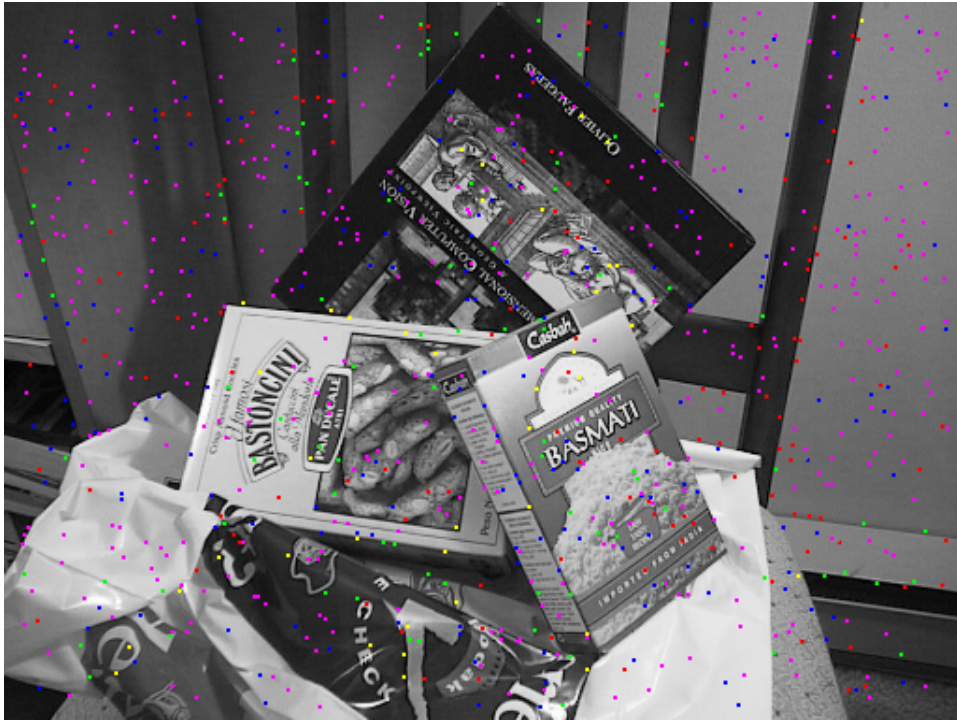
Fig. 7.8: Marcas de la imagen para una ventana de 7 \times 7 y un umbral k = 2 . Los puntos azules y magentas se corresponden con los niveles inferiores de escala.
