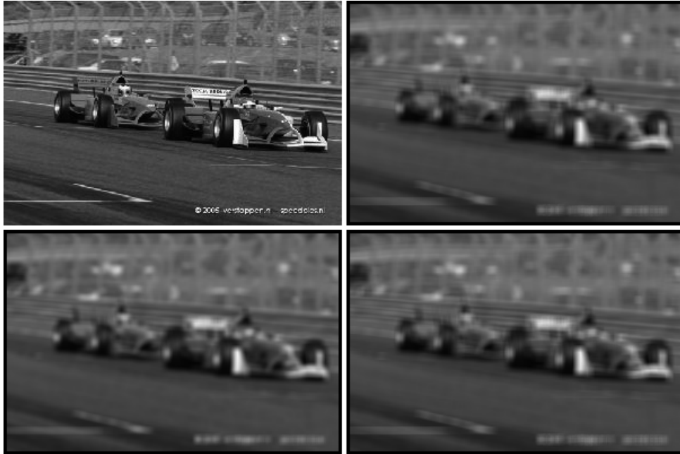
Fig. 7.1: Espacio-escala de una imagen. La imagen superior izquierda es la original, es decir el nivel cero. La imagen inferior izquierda corresponde al primer nivel, la superior derecha, al segundo y la inferior derecha, al tercero.
