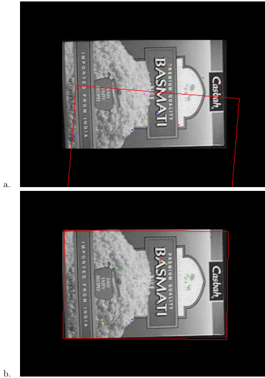
Fig. 7.15: Comparación de los resultados del apareamiento de una imagen (ver fig. 7.14) usando: (a) la transformación de Hough, y (b) RANSAC
