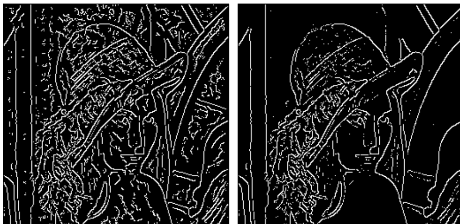
Figura 5.17: Bordes detectados sobre Lena. A la izquierda se muestra el resultado crudo de la selección mediante el método de evolución a través de las escalas. A la derecha se muestran los bordes mejorados mediante un pequeño umbralado.
