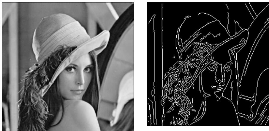
Figura 5.32: Bordes de Lena utilizando el método de Canny.
