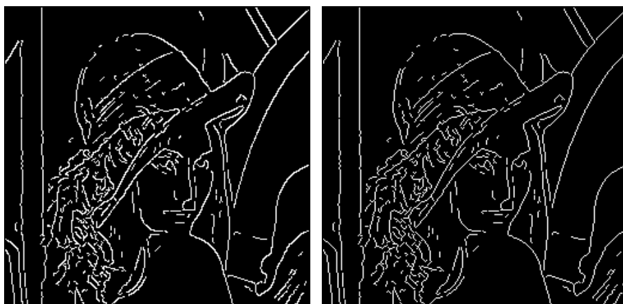
Figura 5.18: Bordes detectados sobre Lena. Resultado luego de eliminar todas las islas conexas de menos de 4 píxeles sobre la imagen binaria de la figura 5.18 (izquierda). Resultado de aplicar una operación de morph binario que reduce el grosor de los bordes detectados (derecha).
