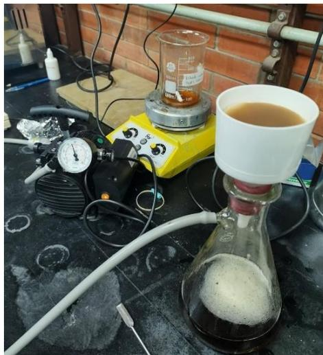
Figura 9. Dispositivo para el tratamiento fisicoquímico del efluente.
