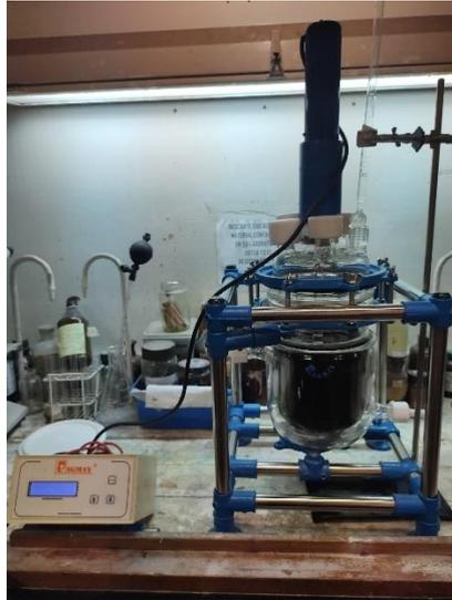
Figura 6. Biorreactor usado para el proceso de concentración química de la bilis bovina.
