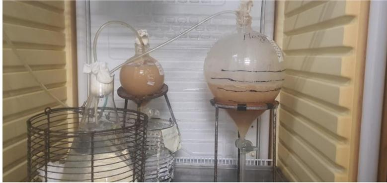
Figura 8. Biorreactores usados para el mantenimiento de los barros activados. En la ampolla pequeña se mantuvo el barro donado por el INTI y en la ampolla de mayor volumen se mantuvo el barro activado propio.
