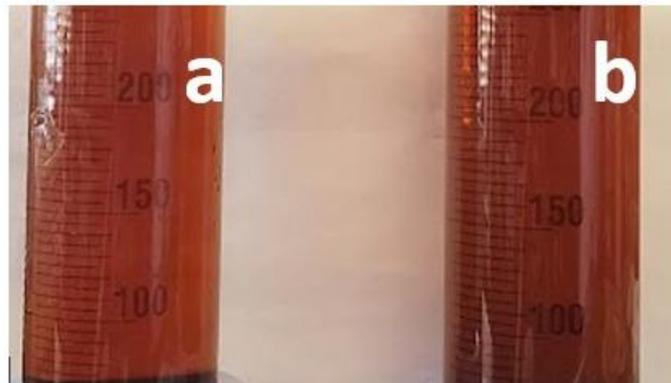
Figura 17. Aspecto del efluente filtrado (a) y crudo (b). En la foto se puede observar la diferencia en color y transparencia entre el efluente filtrado y el efluente crudo.
