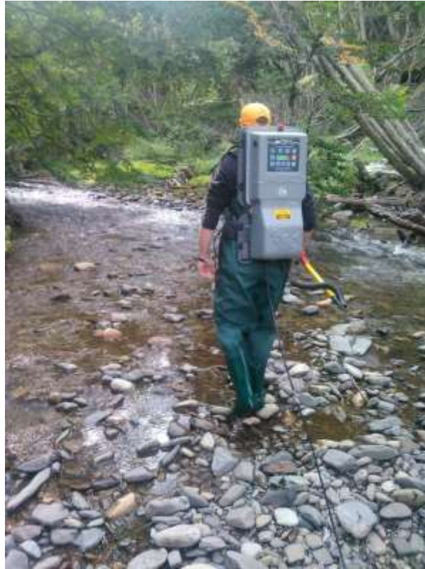
Figura 12: Equipo de electropesca Smith-Root empleado para capturar juveniles de salmón coho. Río Almanza.
