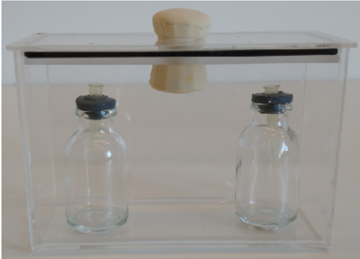
Figura 4: Imagen de una cámara de evaluación. Se puede observar dentro de la cámara los dos frascos-trampa de vidrio con un tip de entrada. En la tapa de la cámara se observa la abertura con el tapón de goma espuma.
