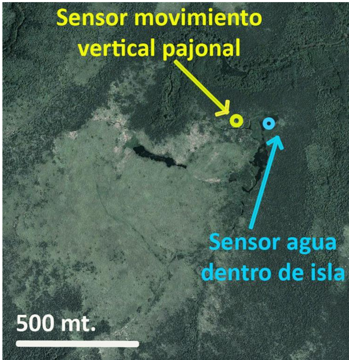
Figura 4.7 Detalle del Pajonal 1, con ubicación de los sensores de movimiento vertical para agua y suelos.
