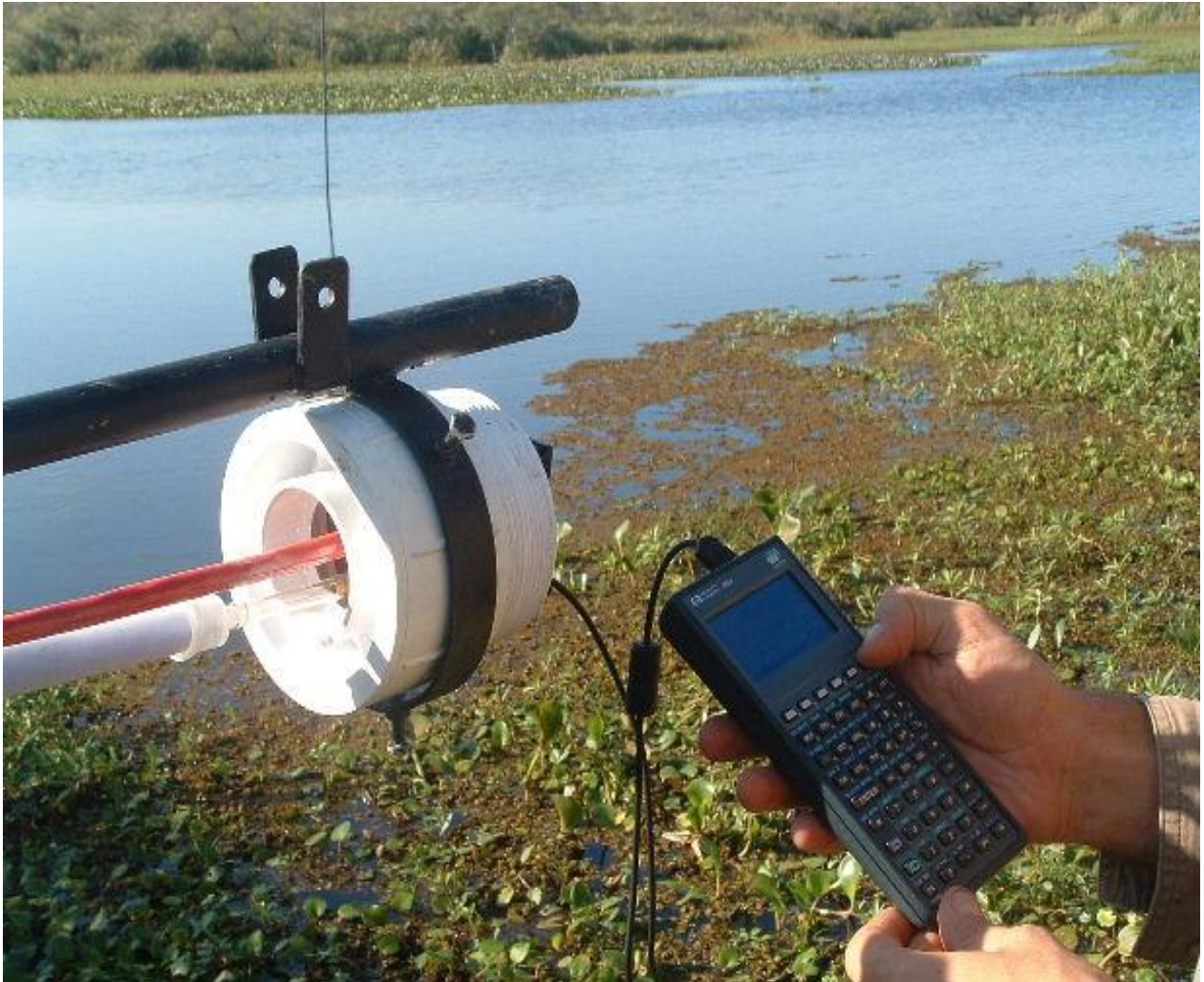
Figura 4.8 Interfase para la configuración de los sensores de movimiento vertical y recuperación de datos registrados. Se tomó un registro de altura cada hora durante un período de un año.
