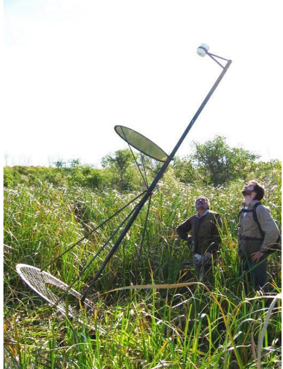
Figura 6.1 Soporte del sensor de movimiento vertical del pajonal, quebrado al final del período de muestreo
