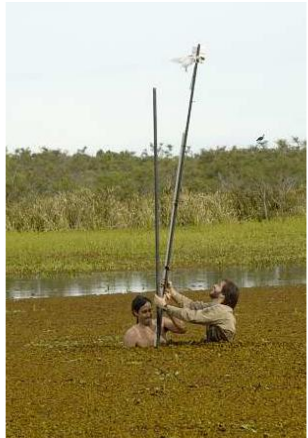
Figura 4.4 El sensor de altura de agua interna fue colocado en el centro de una laguna interior.
