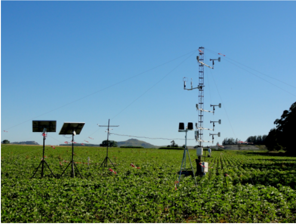
Figura 2.6: Torre micrometeorológica de medición e instrumental complementario situado en el lote experimental, durante la campaña 2012-2013.
