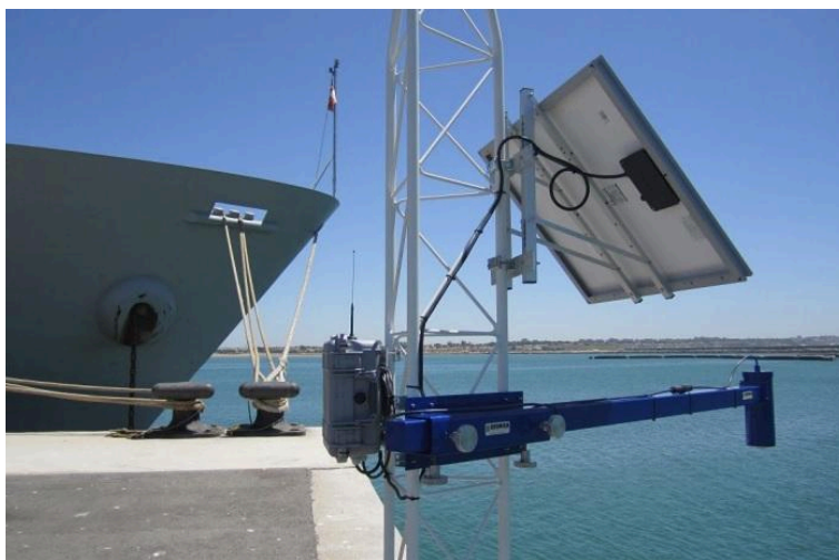
Figura 3.5: Mareógrafo de radar en instalación portuaria.
