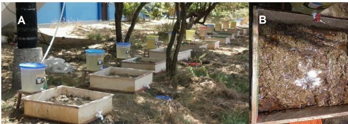
**Figura 2.** Ensayo de biorremediación de suelo de manglar contaminado con petróleo. A) Disposición de los cajones conteniendo el sustrato contaminado con petróleo, se aprecia los baldes para abastecimiento y recojo del agua, B) Vista del sustrato húmedo contenido en uno de los cajones.
