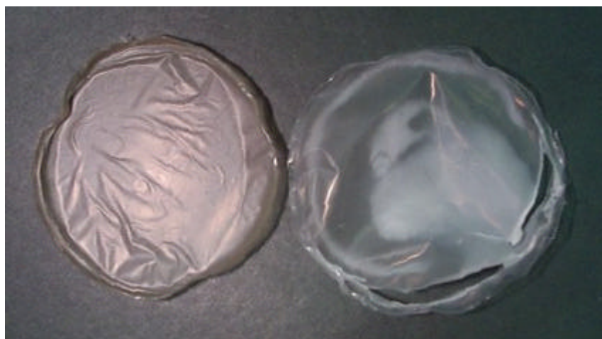
Figura 5. Trozos de polihidroxibutirato (PHB) extraído de cultivos bacterianos. . izq) Azotobacter sp FA8 crecida en medio mínimo con 3% de glucosa der) E. coli recombinante (contiene los genes estructurales pha de Azotobacter sp. FA8) crecida en medio mínimo con 2,5 % de lactosa
