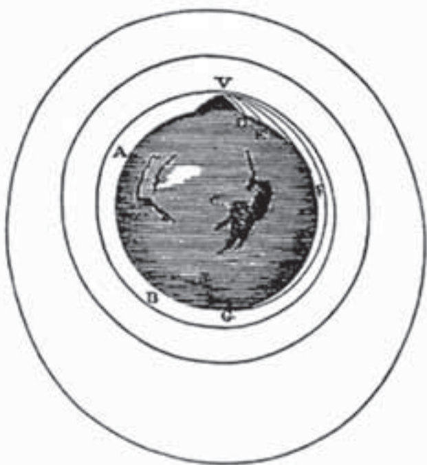
Estar en órbita es una de las muchas formas en que puede caer un cuerpo, cuando se lo arroja horizontalmente con suficiente velocidad. (Idea y dibujo originales de Isaac Newton, publicados en 1684 en sus Principios matemáticos de filosofía natural.)
