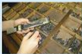
Componer e herramienta para armar un trazo y caja de tipos móviles
