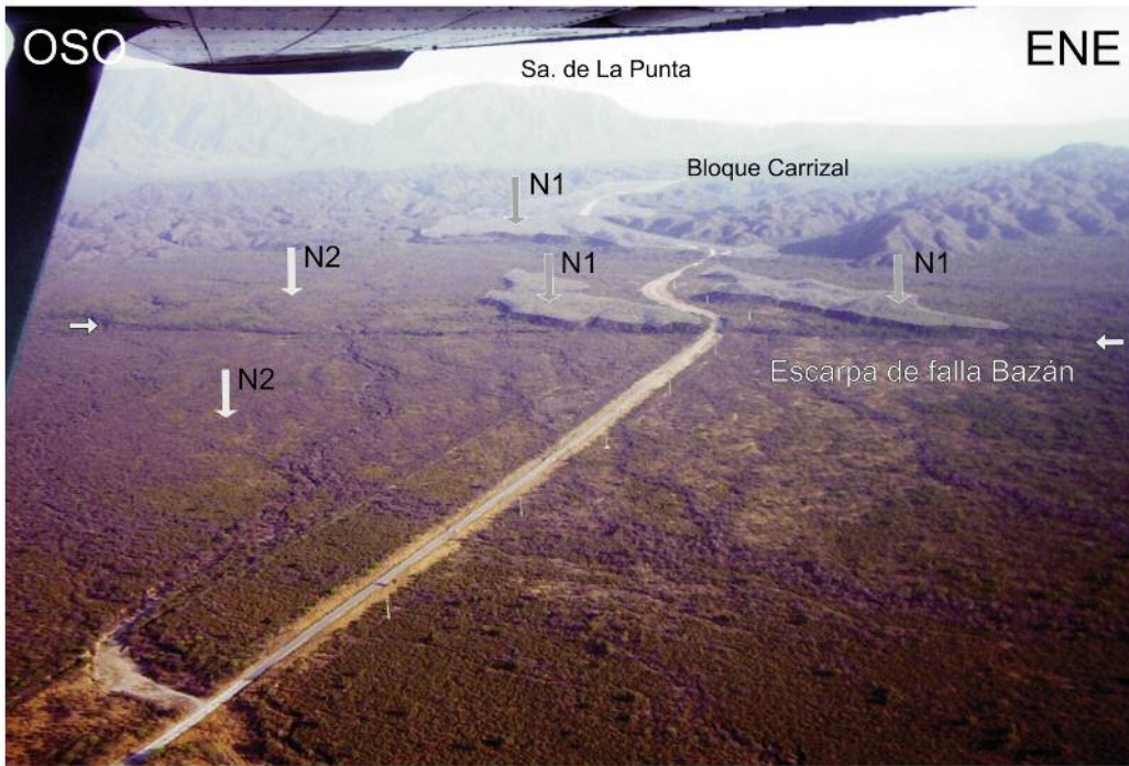
Figura 5: Fotografía aérea oblicua de la escarpa de falla Bazán donde se observan los dos niveles aluviales cuaternarios (N1, N2, Fig. 3) desplazados por la estructura. Se observa el cruce de la ruta provincial N° 9 donde se realizó el corte estructural (Fig. 6, punto b en Fig. 3) (modificado de Costa 2008).
