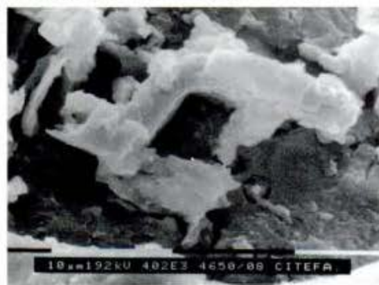
Figura 8: Microfotografía de microscopio electrónico de barrido. Desarrollo de cristales de dolomita hueca ( hollow dolomite ).
