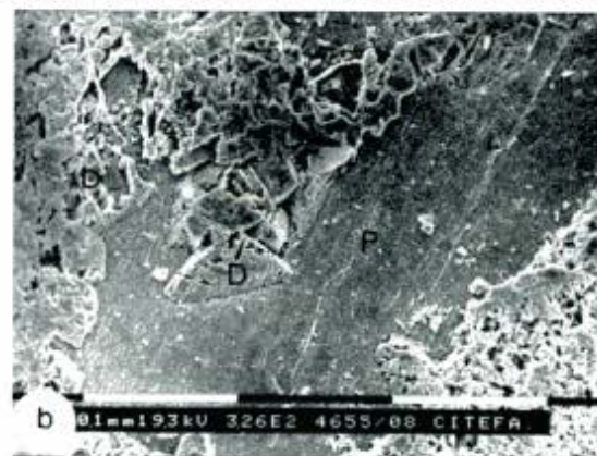
Figura 6: a, Cristales de dolomita nucleados ( \blacktriangledown ) y fragmentos de pelecípodos (O) y equinodermos (B). b, Microfotografía de microscopio electrónico de barrido. Bioclastos fragmentados afectados parcialmente por dolomitización. Pelecípodo (P), dolomita (D).
