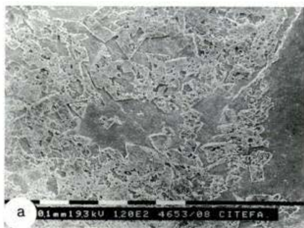
Figura 7: a, Microfotografía de microscopio electrónico de barrido. Cristales de dolomita. Observar su distribución en parches. b, Microfotografía de microscopio electrónico de barrido. Observar las cavidades de disolución en cristales de dolomita euhedrales.
