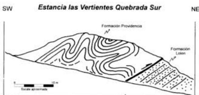
**Figura 8:** Perfil esquemático donde se observa el contacto entre las Formaciones Providencia (Devónico inferior) y Lolén (Devónico superior) mediante un corrimiento inclinando al sudoeste en el sector de la Estancia las Vertientes.
