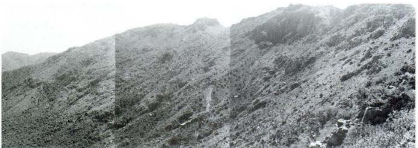
Figura 7: Vista del área de la escarpa de "arranque" desde el espolón sur. Se pueden observar sistemas de diaclasas y fracturas con carácter de dipping-out .
