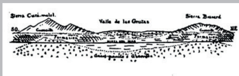
Holmberg a edad madura y su interpretación en una sección transversal de rumbo sudoeste-noreste de la estructura regional en las Sierras de Curá-Malal y Bravard y una sección de detalle (Holmberg, 1884).
