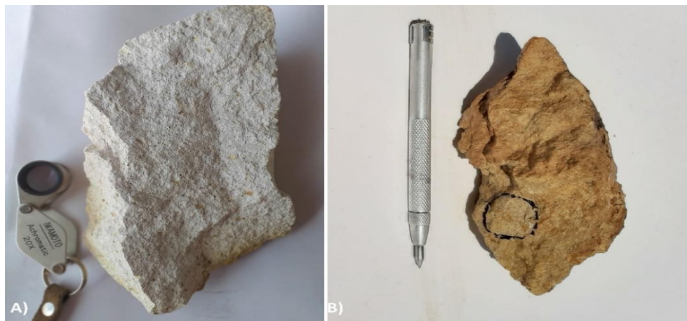
Figura 27. A) alteración Cuarzo-Arcilla ( \pm Alunita); B) alteración Cuarzo-Alunita ( \pm Arcilla).
