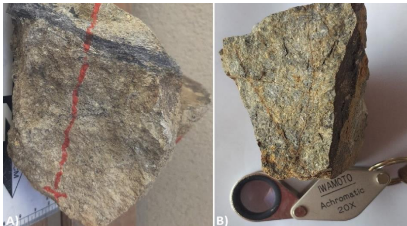
Figura 28. A) andesita porfírica con alteración SCC y microvetillas; B) alteración propilítica progradante.
