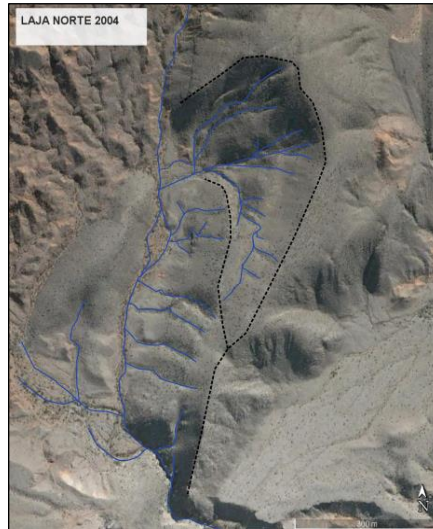
Figura 59. Imagen satelital del 2004, mostrando el drenaje previo a la formación de la cantera correspondiente a la zona de La Laja, San Juan. El sector norte con mayor densidad de drenaje, coincide con el volumen de cavernas observado en la actual explotación.
