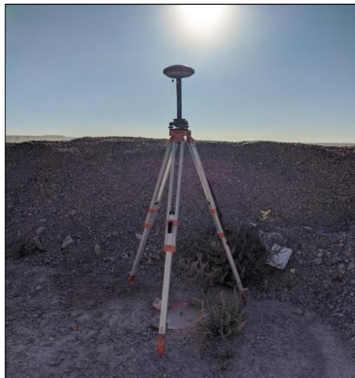
Figura 2. Estación del GPS geodésico, utilizado para la medición topográfica y corrección de puntos en las canteras en operación.
