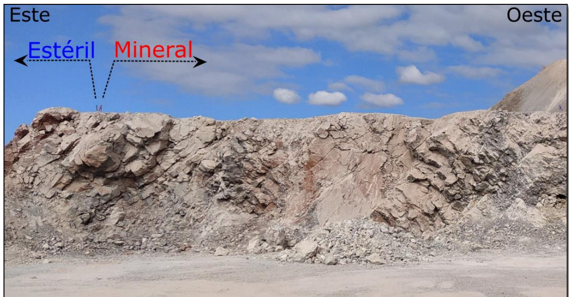
Figura 6. Delimitación de un bloque de voladura, utilizando estacas de 1 metro en cantera. Se define en función del relevamiento geológico y el análisis químico de los pozos. La estaca roja corresponde al mineral y la azul a estéril.
