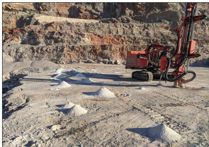
Figura 8: Equipo de perforación de aire reverso con los conos de material perforado correspondiente a un bloque de voladura, siguiendo una malla de 3 por 4 metros.
