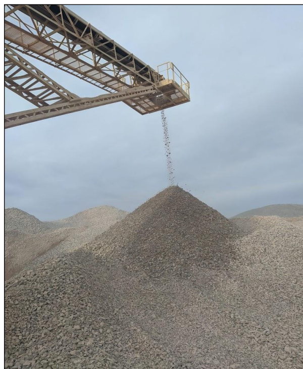
Figura 50. Stock de material acopiado 2-4" luego del proceso de trituración, previo a la incorporación al proceso de calcinación.
