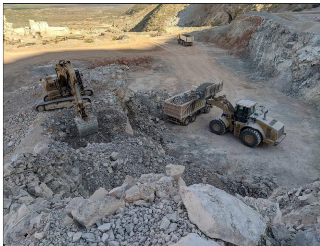
Figura 9. Equipos habituales para las operaciones de canteras de calizas. Movimiento del material en un frente en explotación.
