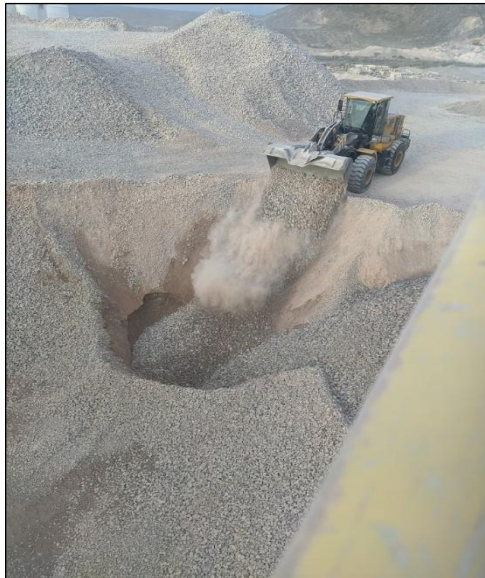
Figura 51. Movimiento de material para alimentación de cinta de hornos.
