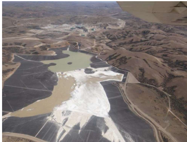
Figura 5.22. Dique de cola de la planta de procesos ubicado en el área de Vein Zone, mina Cerro Negro (Informe Goldcorp 2015).
