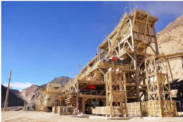
Figura 5.10. Cintas de transporte que llevan el mineral desde los lugares de extracción hasta la unidad de trituración, donde se reduce la roca hasta el tamaño deseado, para luego ser conducida por cintas transportadoras hasta la pila de lixiviación (Mining Press/SI 2020).
