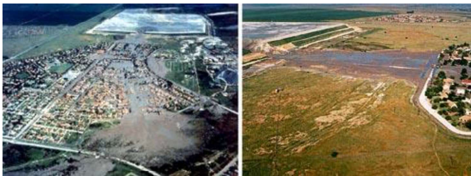
Figura 6.5. Fotografías aéreas del alcance del derrame de Merriespruit y la corta distancia que separaba el dique del pueblo vecino. Luego del colapso del dique el deslizamiento viajó por 2 km cubriendo una superficie de 500.000 m 2 (Davies 2002). Fuente: https://www.tailings.info/casestudies/merriespruit.htm .
