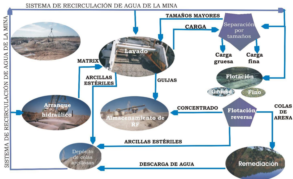
Figura 9. Esquema de procesos de extracción y tratamiento de rocas fosfáticas. (i) Arranque hidráulico; (ii) Lavado y separación de estériles; (iii) Separación por tamaños de grano; (iv) Almacenamiento de concentrado de rocas fosfáticas y del desecho de arcillas estériles en pilas (Tomado de Castro y Melgar, 2005).
