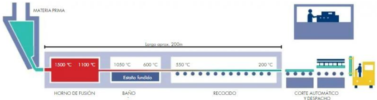
Figura1. Esquema general de horno de vidrio (Modificado de Catálogo de productos VASA 2006/2007 2007).
