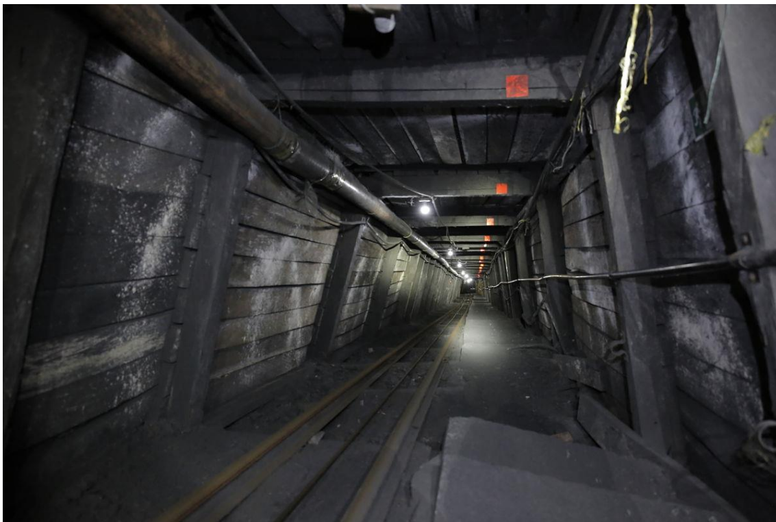
Figura 32. Galerías con sostenimiento de madera en mina ubicada en el CEOC. Tomado de Web Esmeraldas Santa Rosa S.A. https://www.esmeraldassantarosa.com/
