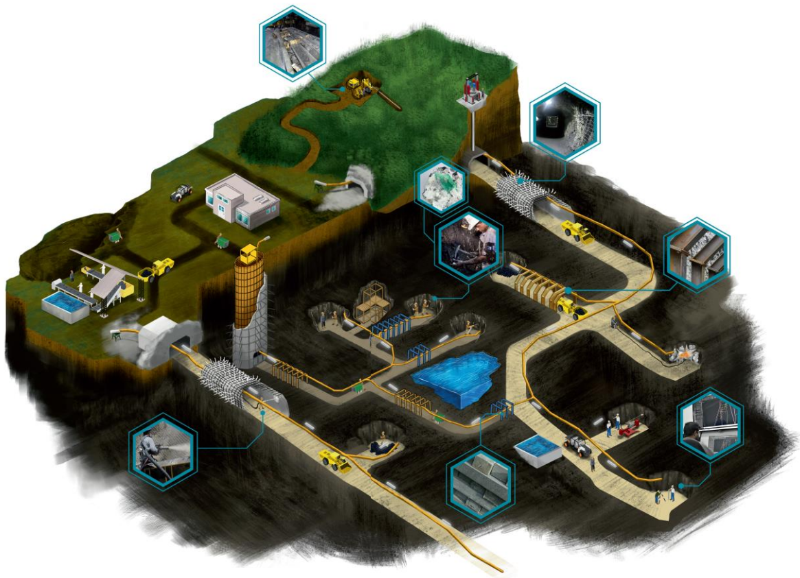
Figura 35. Modelo operativo para la extracción de esmeraldas en el CEOC. Método de explotación: Minería subterránea operada por MTC a través de galerías y rampas. Tomado de Minería Texas Colombia S.A (2017).
