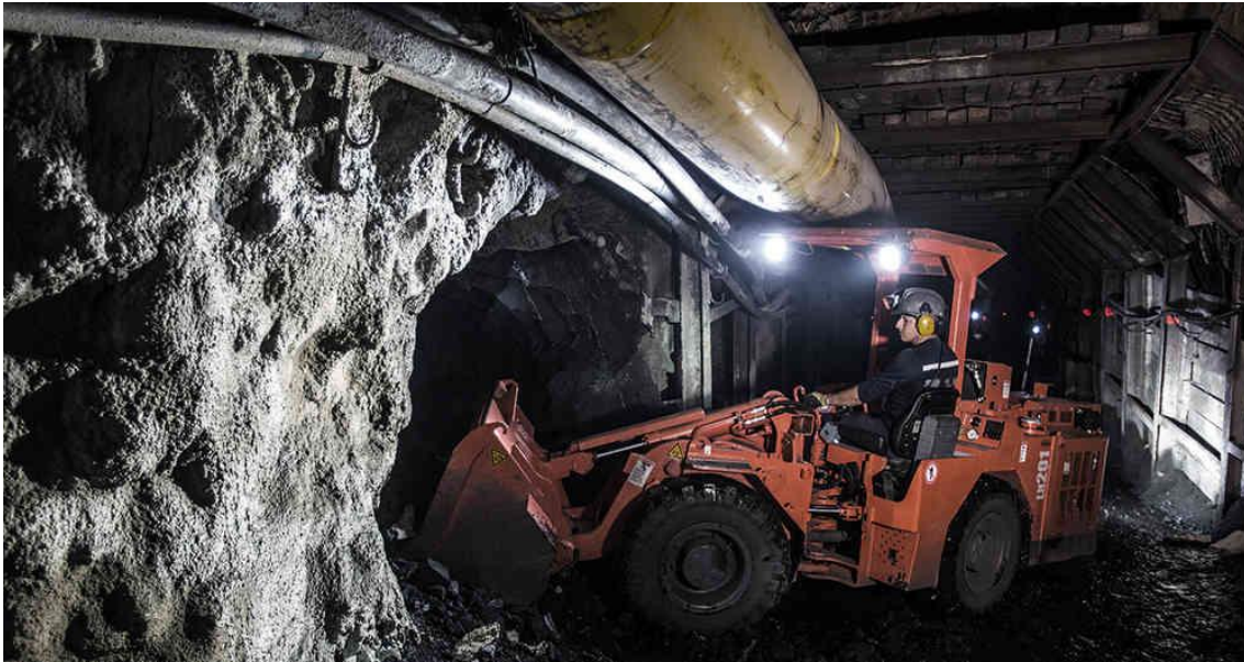
Figura 33. Rampa con sostenimiento de puertas metálicas y shotcrete en mina ubicada en el CEOC. Tomado de Semana (2017).
