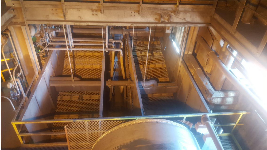
Fig. 17: Vista de las zarandas N°17, donde también pueden verse los rociadores para el lavado del carbón bruto. En la parte inferior se puede observar el separador de tambor (DISA).
