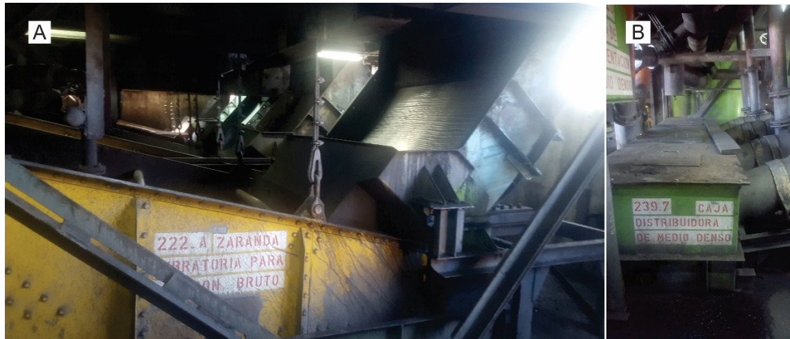
Fig. 19: A) Zarandas N°222, donde se puede observar la zaranda curva (estática), seguido por una vibratoria horizontal. B) Hidrociclones de medio denso.
