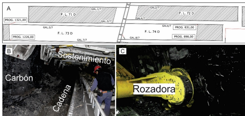
Fig. 14: A) Plano esquemático de algunos paneles de explotación (FL= frente largo) correspondientes a la zona del Chiflón 7 de Mina 5. B) Puede verse el manto de carbón, el equipo de sostenimiento y las cadenas blindadas de evacuación del material minado. En C) se ve el equipo de corte del carbón (rozadora).
