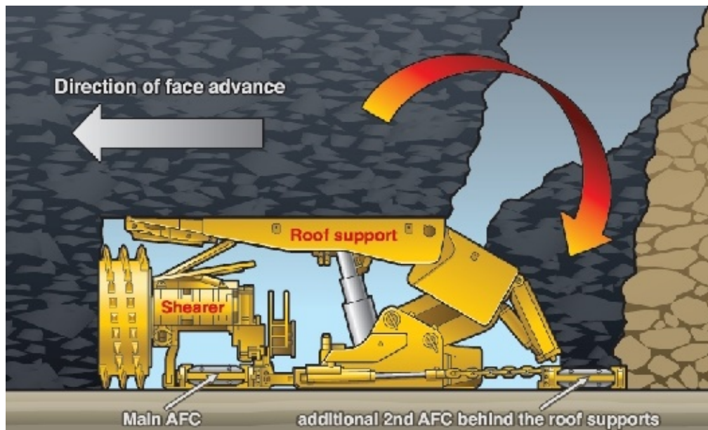
Fig. 13: Sistemas que componen el frente de explotación: Soporte ( roof support ), corte ( shearer ) y transporte ( main AFC ). Tomado de Caterpillar (2014).
