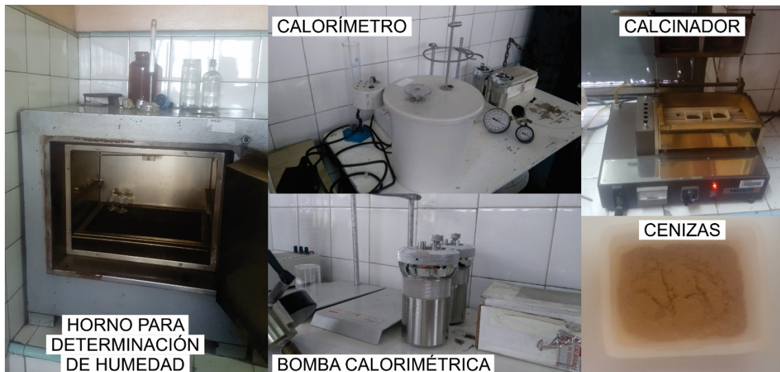
Fig. 30 Equipos del Laboratorio de Planta Depuradora en YCRT para la determinación de humedad, PCS y cenizas.
