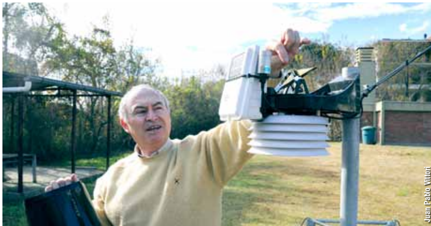
La estación, completamente automática, mide son las clásicas: temperatura, humedad, lluvia, viento y presión. Pero esto puede ser solo el comienzo, “si quisiéramos, por ejemplo, medir la evapotranspiración, le podemos agregar un sensor de radiación solar. Se compra y se enchufa. Es una estación que permite ser actualizada fácilmente”, sostiene Flores
