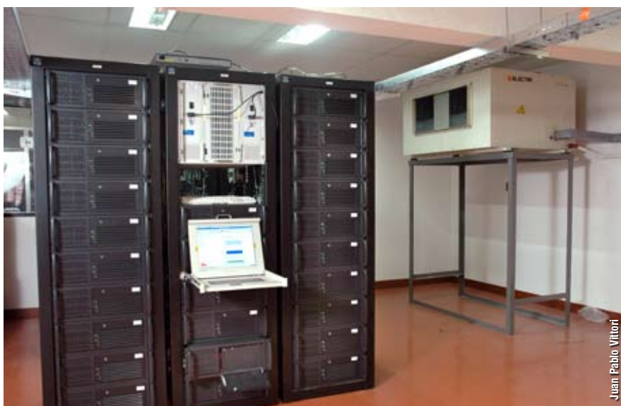
El CeCAR, cuenta con 224 microprocesadores en 56 computadoras conectadas mediante una red de alta velocidad llamada InfiniBand que, mediante lo que se denomina “cálculo paralelo”, podrán resolver problemas de diversas áreas, como, geología, biología, astronomía, química, o ciencias de la atmósfera.
