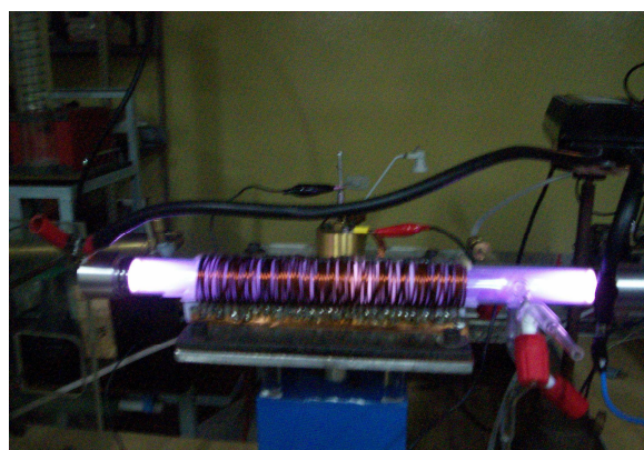
Fig. 6 Luminiscencia de una mezcla de aire y Ar a una presión de \sim 0.5 Torr inducida por ionización mediante la aplicación del campo eléctrico de AF entre las tapas de cierre de la celda empleando el OEC.
