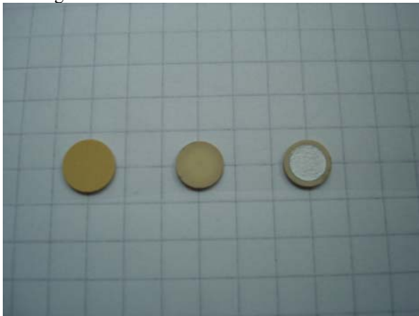
Figura 1. Pastillas de PZT (a) prensada, (b) sinterizada a 950°C y (c) con los electrodos-Ag.
