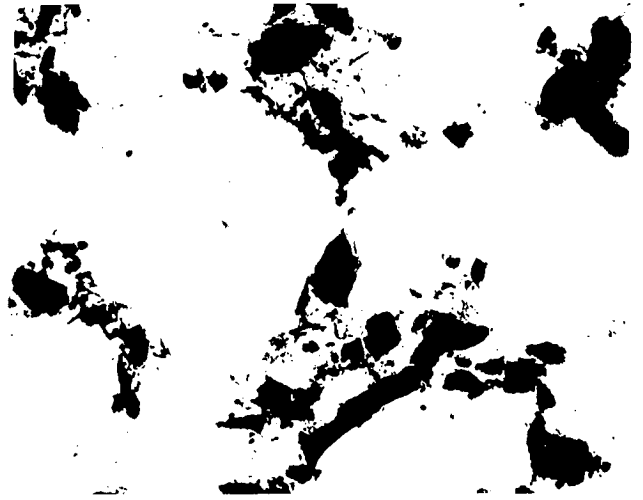
Figura 2: Micrografía del compuesto sinterizado 4 hs a 913 K ( \times 600 ).
